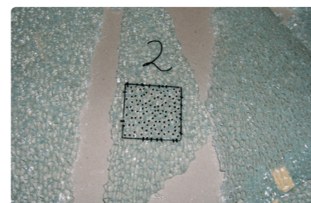
▲ Granulering av herdet glass etter prøving i laboratoriet. Store flak av herdet glass som er knust kan henge sammen og dermed utgjøre en fare ved glassnedfall.
