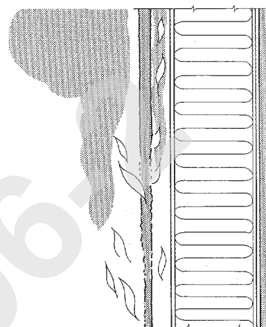
Fig. 11 Brannspredning i utvendig, brennbar kledning
