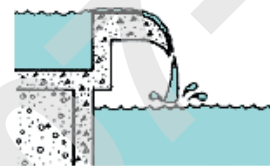
Fig. 531 c Dette gir et lavt vannslør i forhold til fallet.
