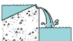
Fig. 531 d Utkasterkant og vannslør
