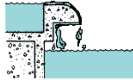
Fig. 531 a Problemet er at vannet kryper langs kanten.
